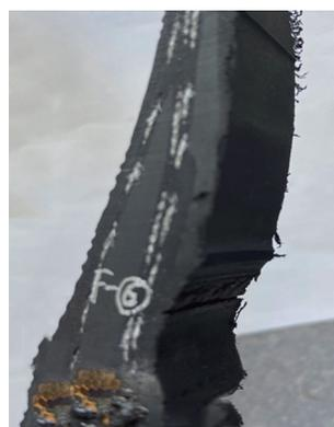
图3 轮辋保护下端胎圈裂口
