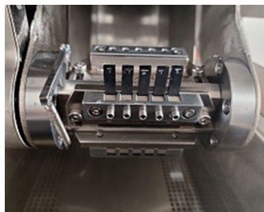
图2 胶料低温脆性测试
