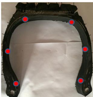
图1 轮胎温度测定位置示意
