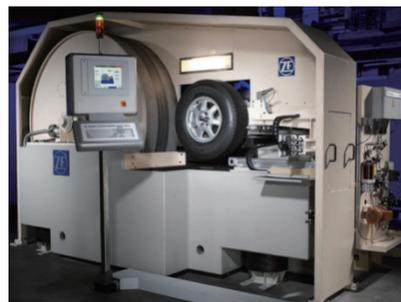
图1 轮胎高速均匀性测试系统
