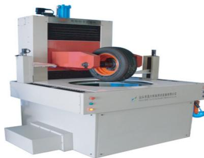
图2 轮胎刚性试验机
