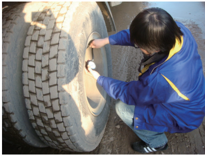
图1 采用气压表测量轮胎充气压力
