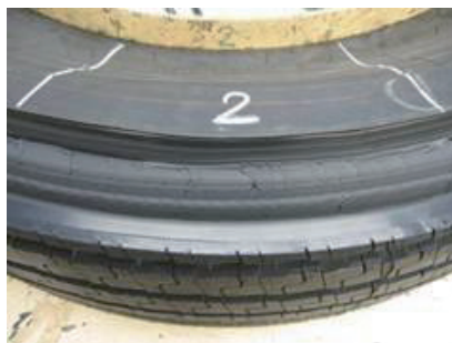
图16 新轮胎胎肩胶料剥离后平滑接合面
