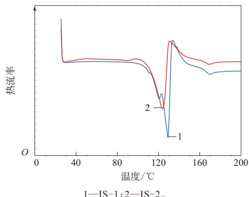
图1  $105\text{ }^{\circ}\text{C}$ 下热处理后不溶性硫黄的DSC曲线
