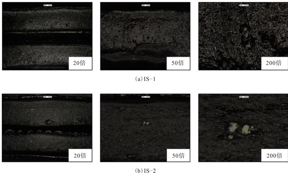
图4 断面胶料中不溶性硫黄的显微镜照片
