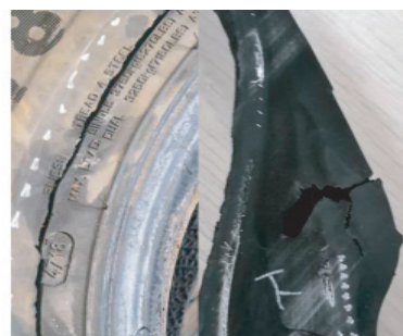
图2 胎圈防水线上方周向裂口
