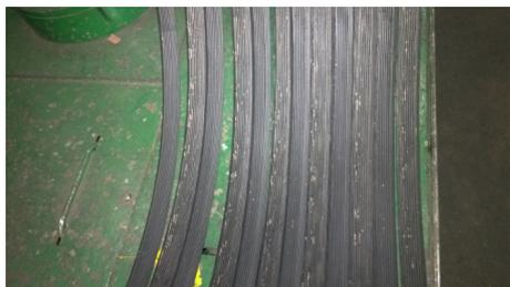
图2 2#配方胎圈钢丝覆胶的覆胶效果
