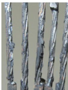
(c) 40 °C × 14 d 盐水 (质量分数为0.1的氯化钠溶液) 老化后
