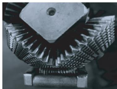
图7 成型缝合器缝合轮
