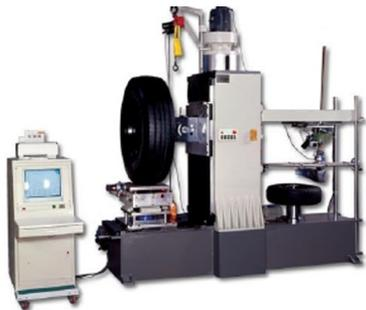
图7 轮胎侧偏性能测试平台
