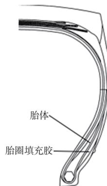
**图1** 全路面起重机用445/95R25轮胎材料分布示意
