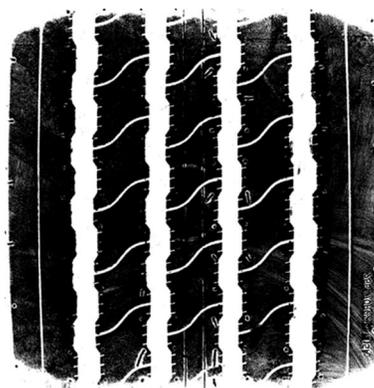
图7 改善方案轮胎实际接地印痕,增大带束层压力分担率可以改善轮胎接地印痕几何形状。
