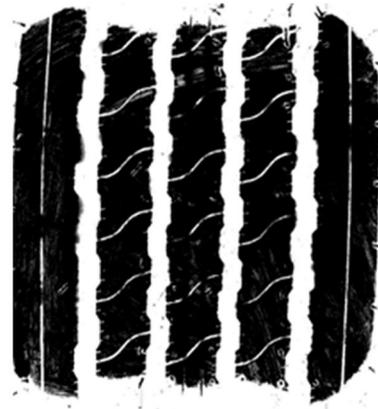
图1 原轮胎实际接地印痕
