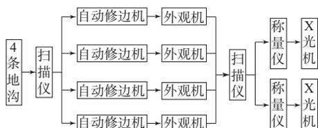
图6 A(B)线物流流程
