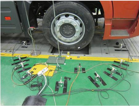
图10 转鼓测试的麦克风布置
