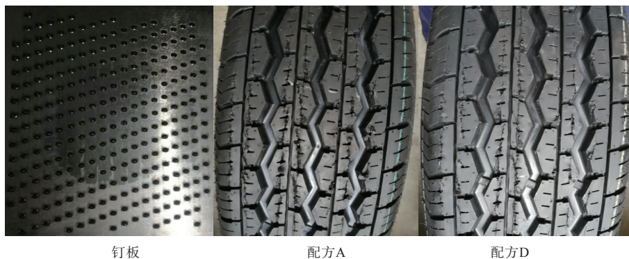
图2 抗刺扎性能测试结果
