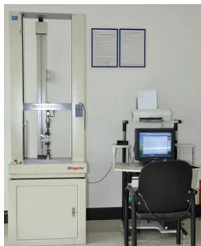
图1 拉力试验机
