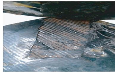
图7 3+9+15×0.22+0.15帘布盐水老化后剥离外观
