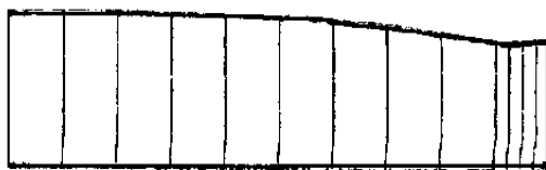
图 7 带束层张力在不同截面上的变化(386 窄)
