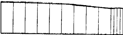
图 13 带束层张力在不同截面上的变化(386 宽) 最大值为 13.091 kN
