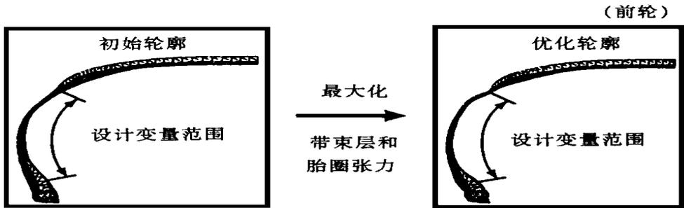
图5 GUTT轮廓应用于低断面赛车轮胎(240/50R13)
